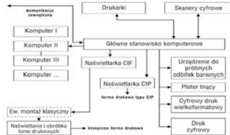
Rys. 4. Przykładowy schemat blokowy systemu DTP [źródło własne].
